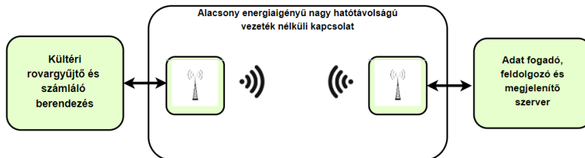
1. ábra - Az automatikus kártevő azonosító és számláló eszköz áttekintő rendszerterve
