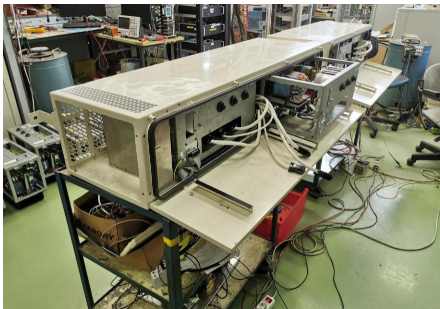
8. ábra: JIPQ825/3x460-12 típusú berendezés végmérése
